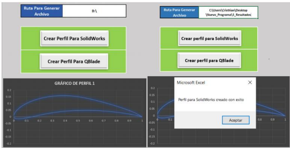
Figure 16. Exporting Warping Data to QBlade Software Source: P. Maldonado, Validación Turbina Hidrocinética, P. Maldonado, Ende Guaracachi
